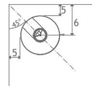
1) Stärke der Dämmschicht, hinten/unten/oben.
