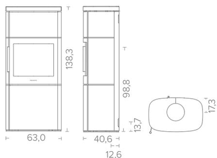
Alle Zeichnungen: Die Maße für den Rauchabgang und den Frischluftanschluss sind bis zur Mitte der Öffnung angegeben.
