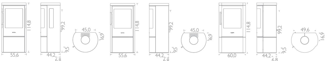
Alle Zeichnungen: Die Maße für den Rauchabgang und den Frischluftanschluss sind bis zur Mitte der Öffnung angegeben.
