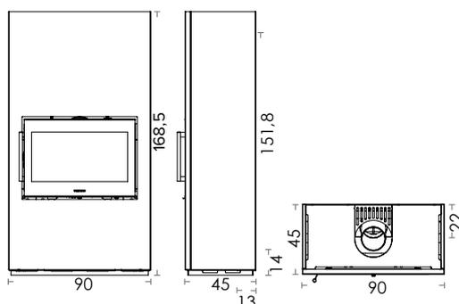
Alle Zeichnungen: Die Maße für den Rauchabgang und den Frischluftanschluss sind bis zur Mitte der Öffnung angegeben.
