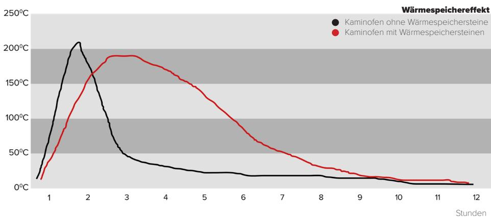
Ein Kaminofen mit wärmespeichersteinen bedeutet bei gleicher Brennholzmenge mehr kontinuierliche Wärme im Raum.
