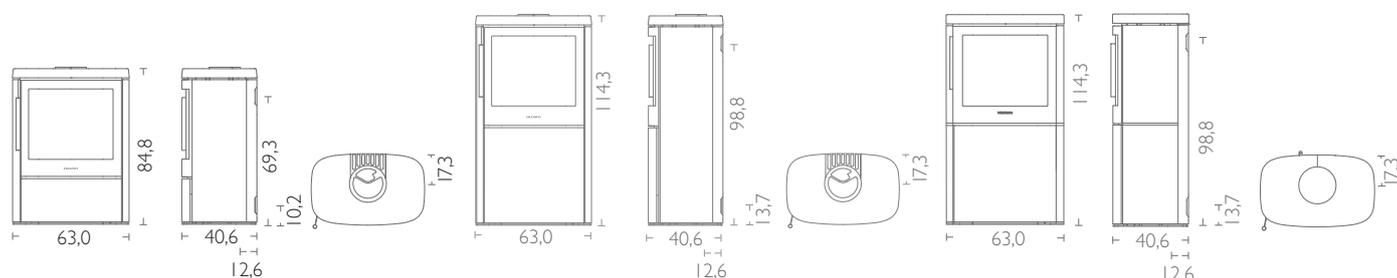
Alle Zeichnungen: Die Maße für den Rauchabgang und den Frischluftanschluss sind bis zur Mitte der Öffnung angegeben.
